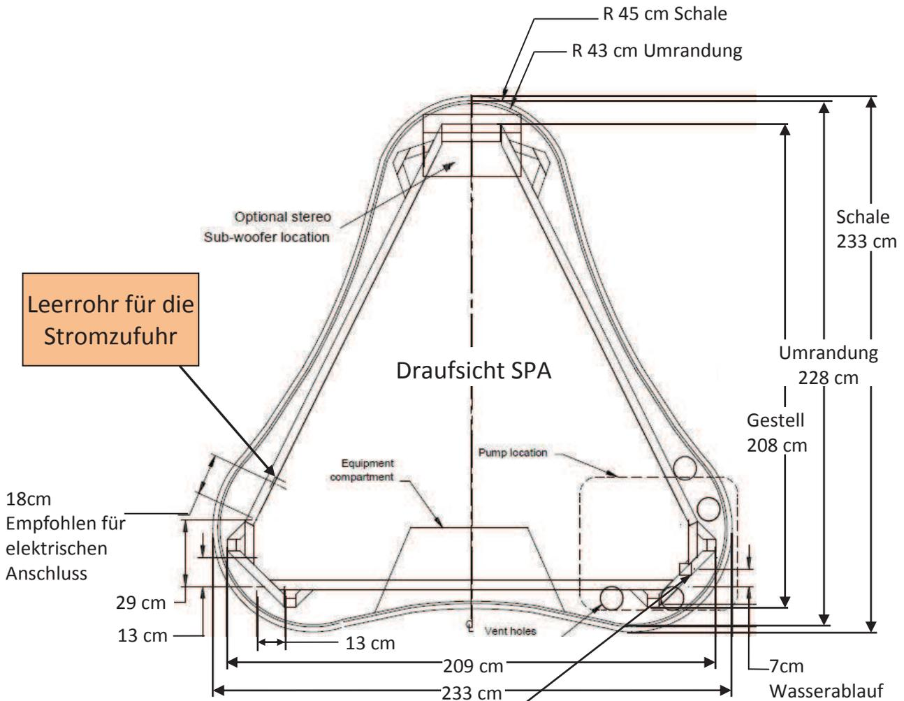
Entleerung Kugelhan3/4" Aussengewinde für Gartenschlauch
