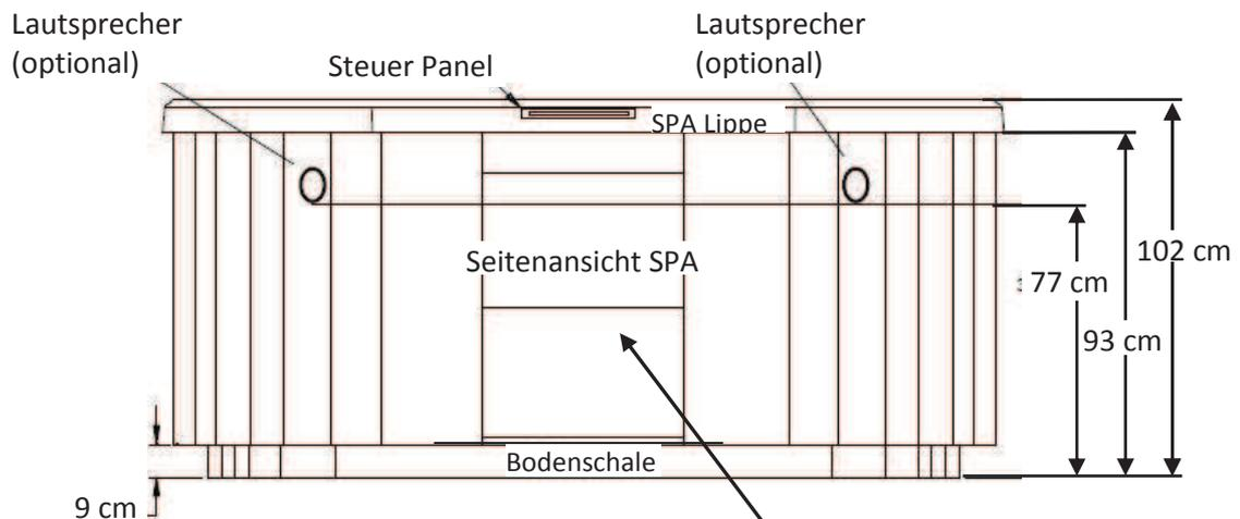
Diese Aussenseite des Whirlpools muss zugänglich und demontierbar sein. Die Technik befindet sich direkt hinter dieser Abdeckung.
